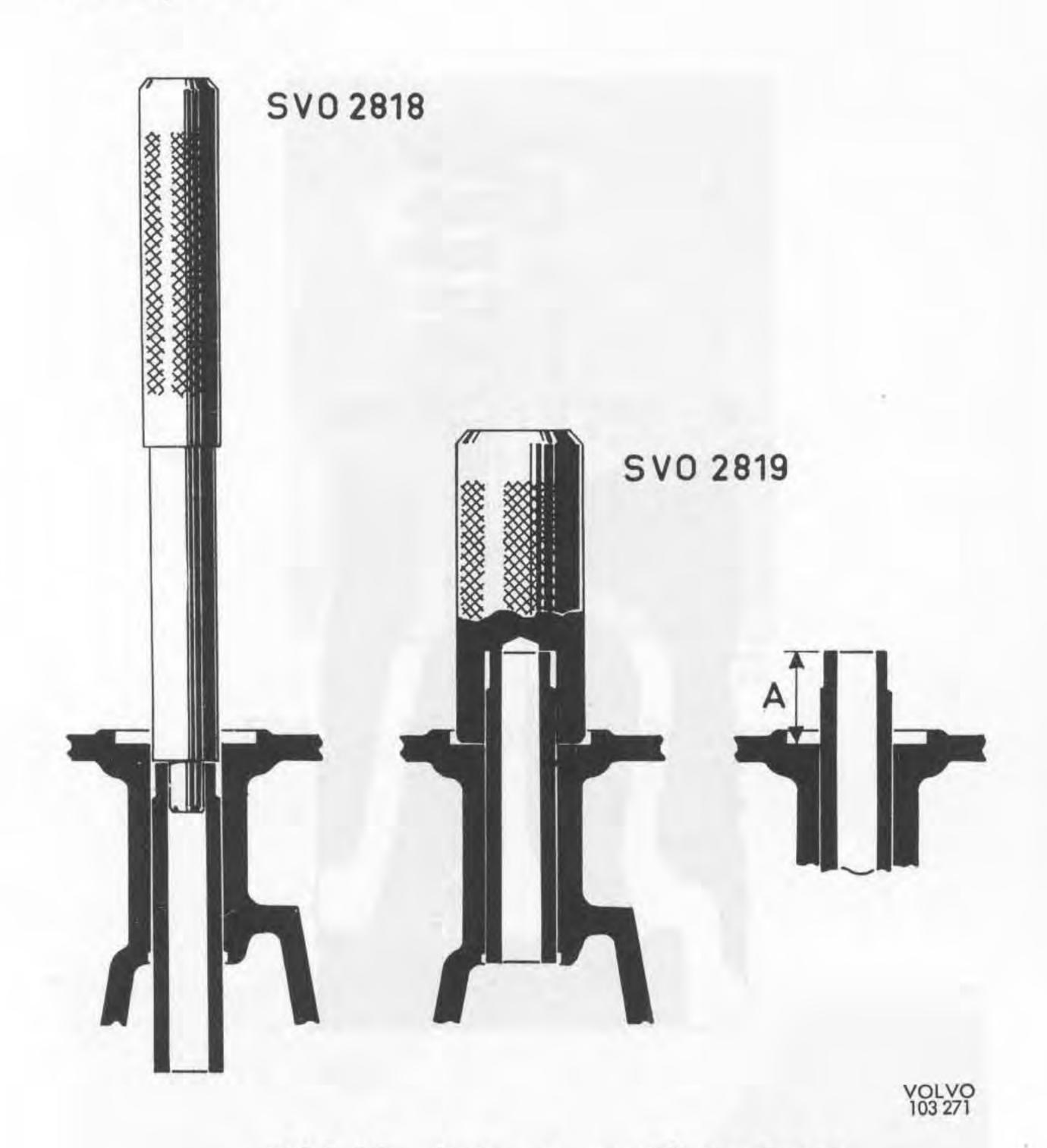
Bild 34. Byte av ventilstyrningar A=17,5 mm (B 20 E/F:A=17,9 mm)
