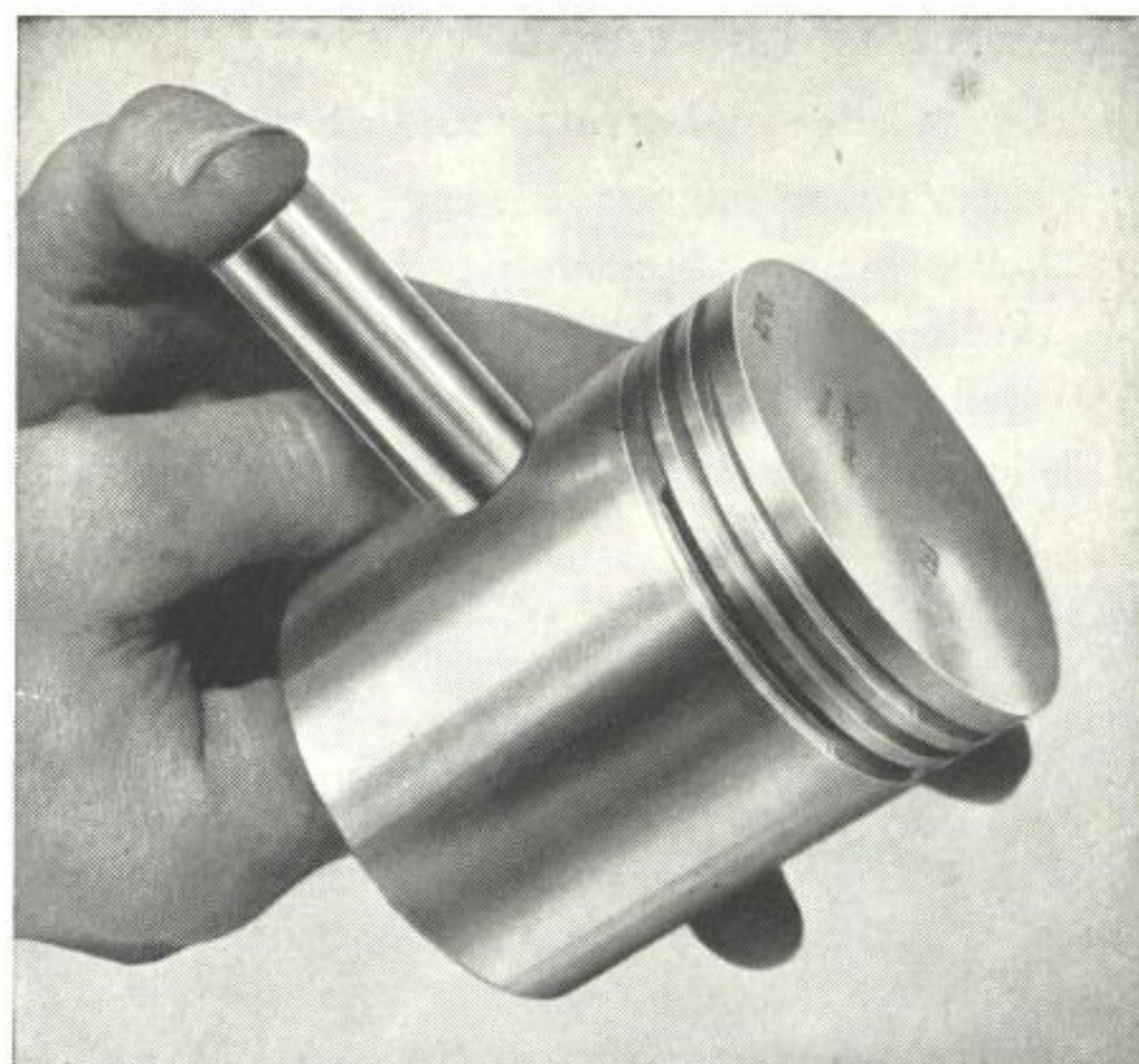
Bild 38. Passning av kolvtapp.
