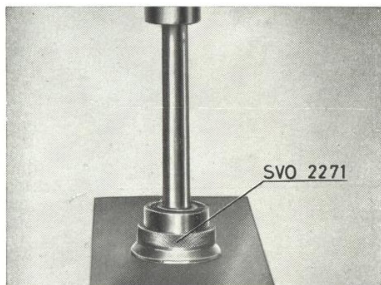
Bild 76. Montering av kullager.
