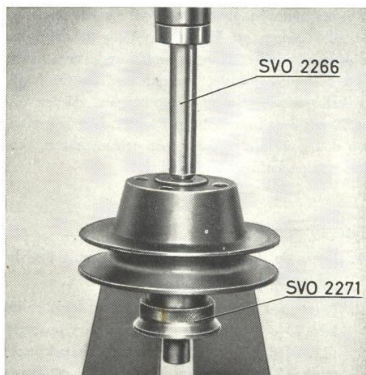
Bild 75. Demontering av remskiva.
