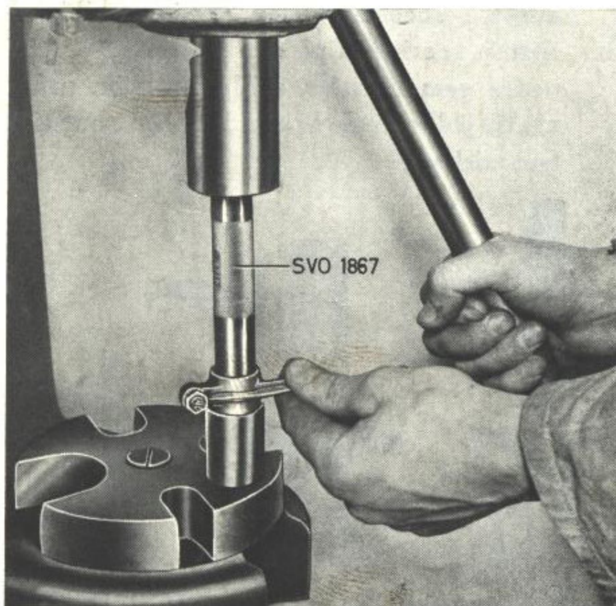
Bild 39. Byte av bussning i vipparm.
