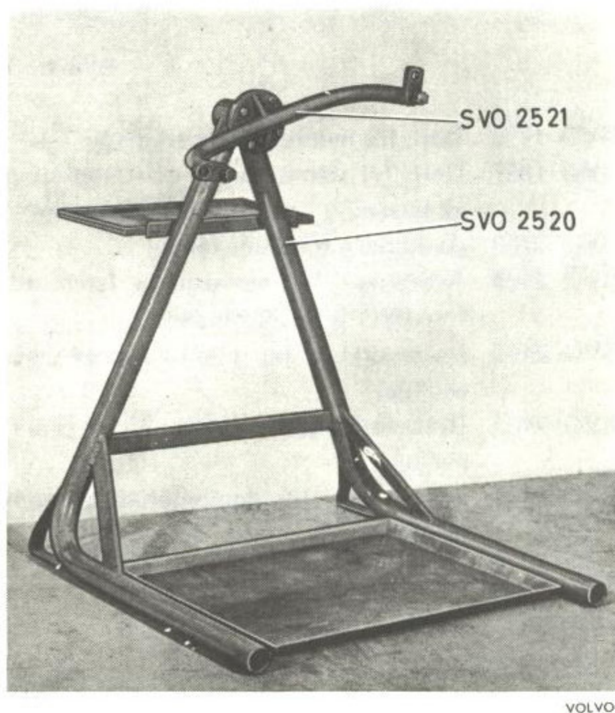
Bild 5. Stativ SVO 2520 och fixtur SVO 2521, för motor
