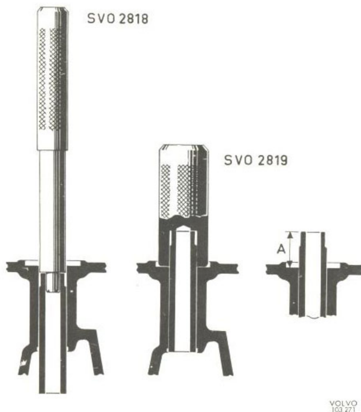
Bild 28. Byte av ventilstyrningar
