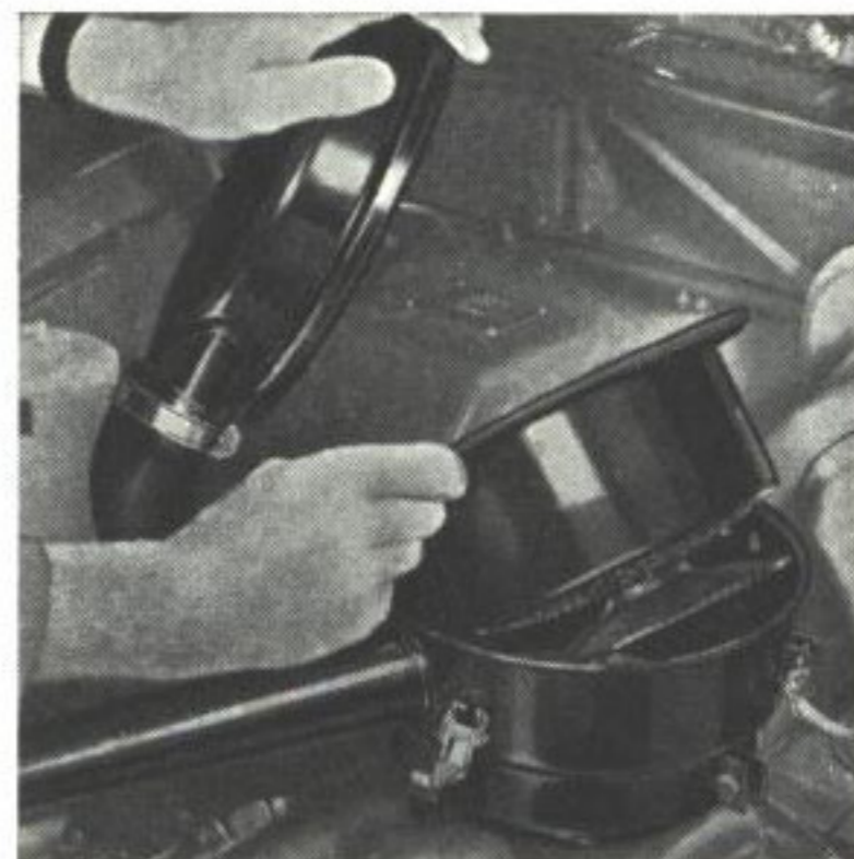
Bild 22. Isärtagning av luftrenare (B 16 B, B 18 B och D).
