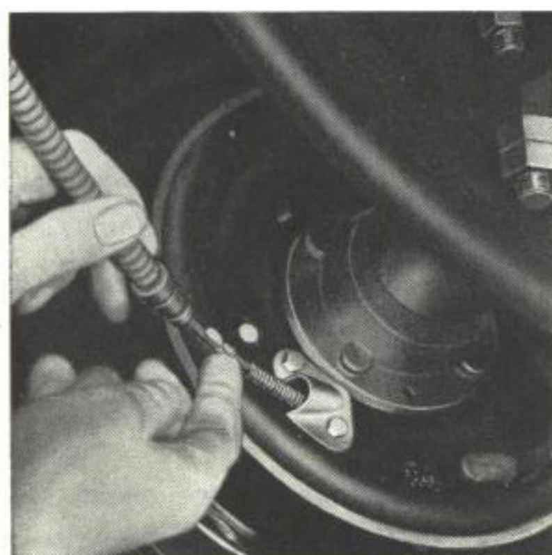
Bild 27. Smörjning av handbromsvajer.
