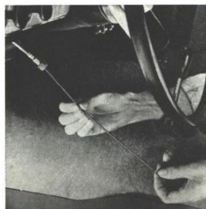
Bild 28. Smörjning av drivlina.
