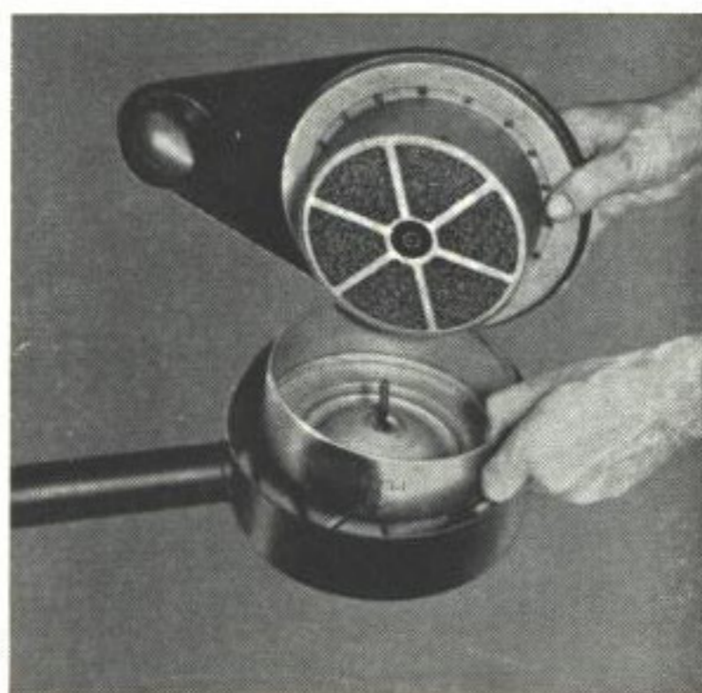
Bild 21. Isärtagning av luftrenare (B 16 A, B 18 A).
