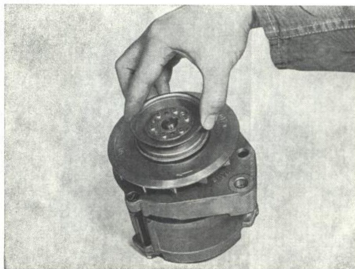
Bild 51. Demontering av remskiva
