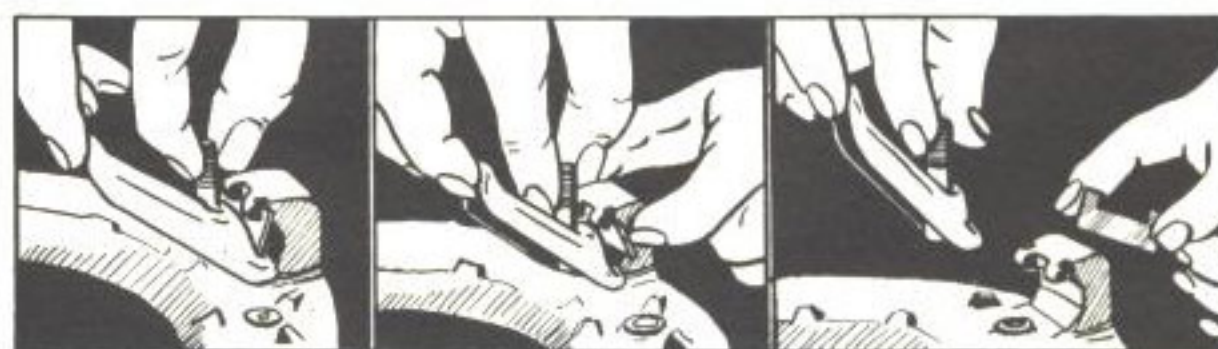
Bild 18. Demontering av hävarmar
