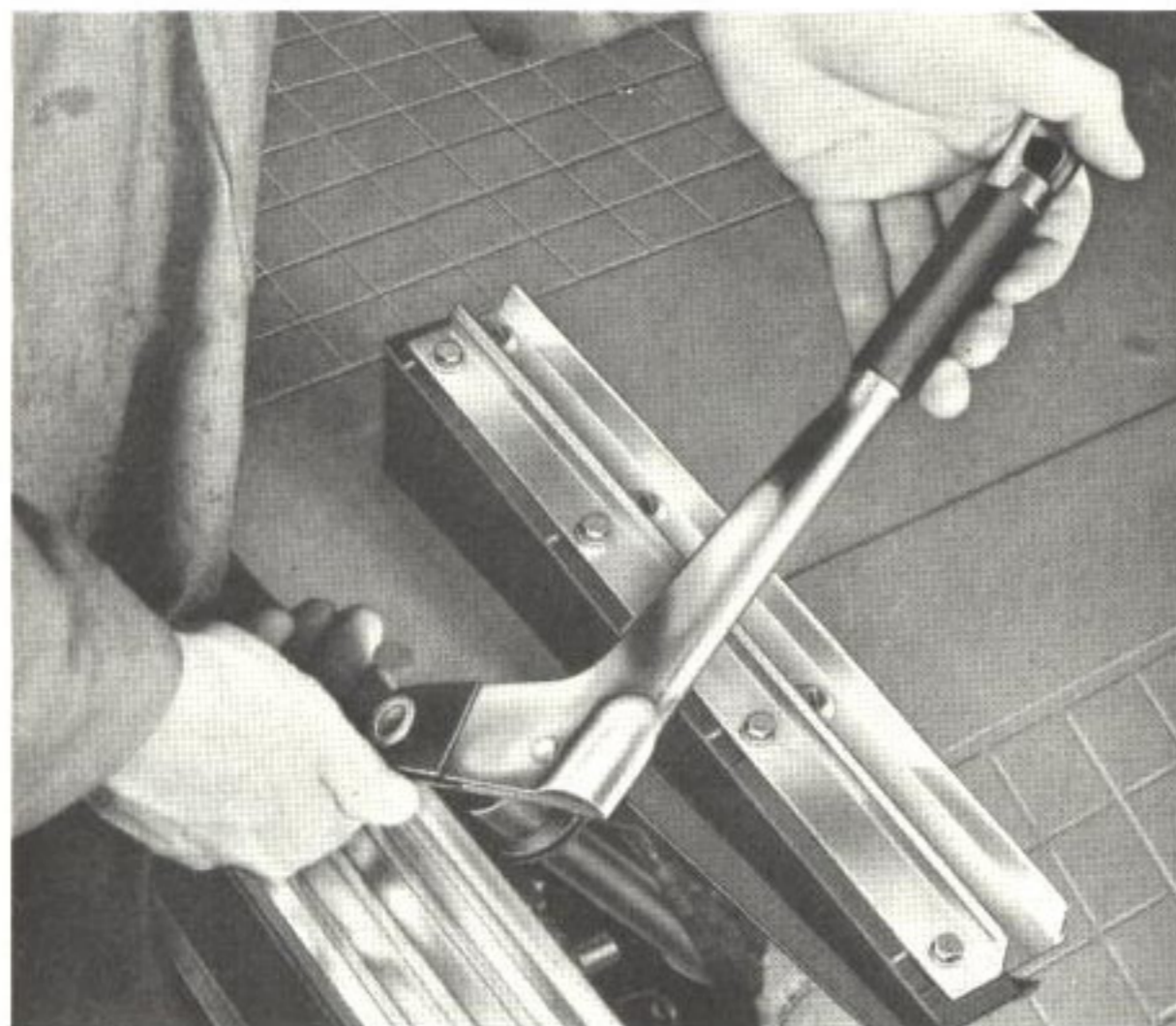
Bild 113. Demontering av spak, 120
